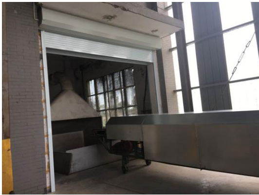
整改后原料输送集气罩收集
