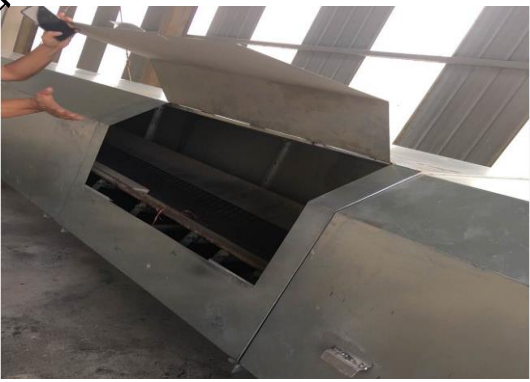
整改后筒仓原粮配料密闭投加
