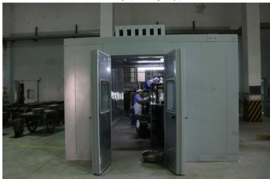
输送装置外加隔音层（隔声罩）
