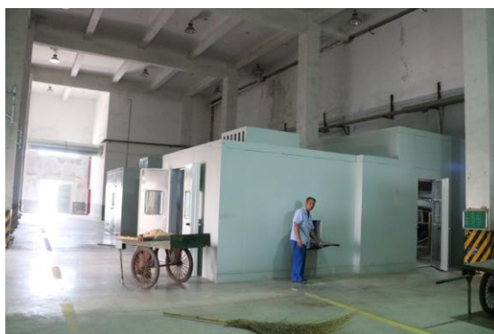
输送装置外加隔音层（隔声罩）
